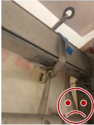
Kuormaliina leikkaantuu kiristyessään.
